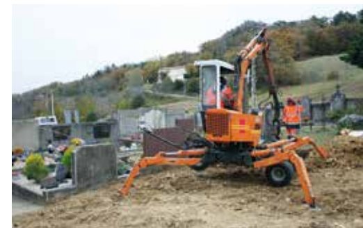
La mini pelle araignée avec laquelle l'équipe de l'entreprise agréée par l'état a réalisé les travaux.
